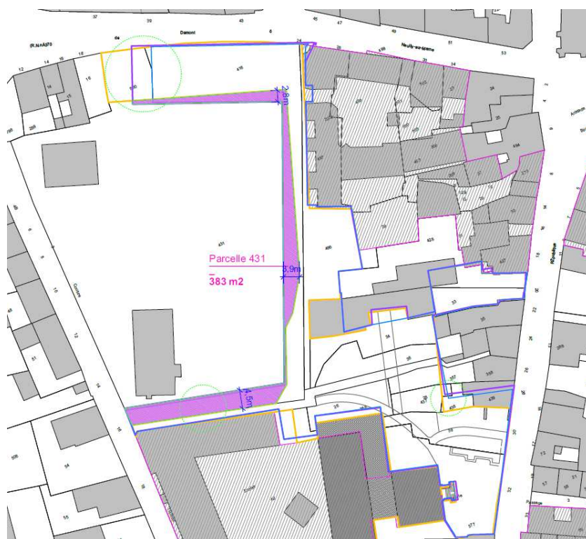
Extrait du plan de division pour l'élargissement de la sente du Coutel – Source : Champ Libre
